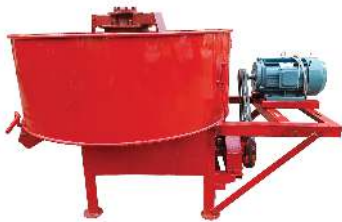
Máy trộn bê tông
